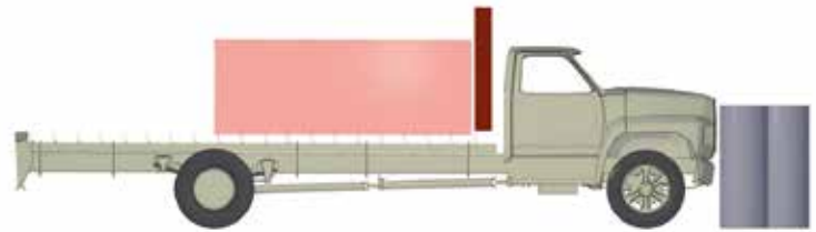
Abb. 6: Brisante Ladung: Betonblöcke (hellrot) und Sprengstoff (dunkelrot)
